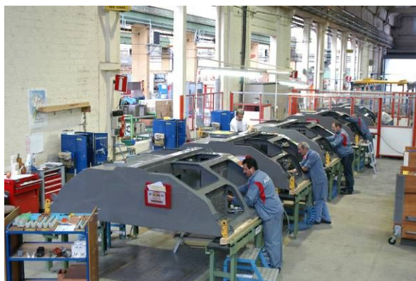
Atelier de fabrication des blocs ou coffres
