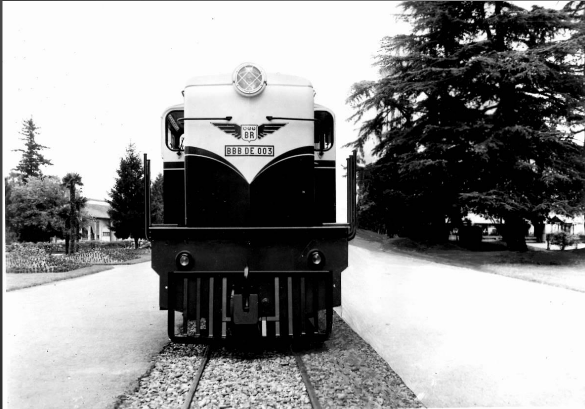
32460 R ALSTHOM CHEMINS DE FER DE BIRMANIE Locomotive Diesel-Electrique, type 888 - 60 1 - Série 001 à 006 Vitesse maximum : 88,5 km/h avec 1 moteur Diesel MGO V 12 ASHR - 1200 ch
